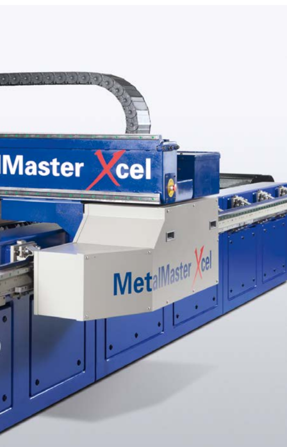
Los engranajes helicoidales con guías lineales ofrecen un accionamiento suave para cortes de alta calidad y precisión
