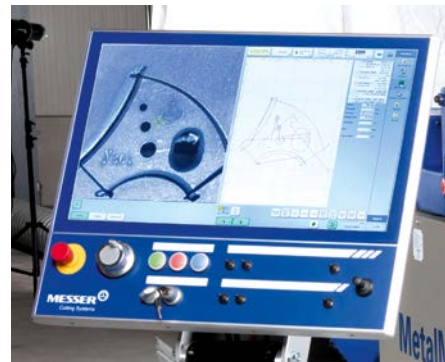
El Global Control con pantalla de 24" ofrece operaciones intuitivas para acelerar la configuración y reducir el error
