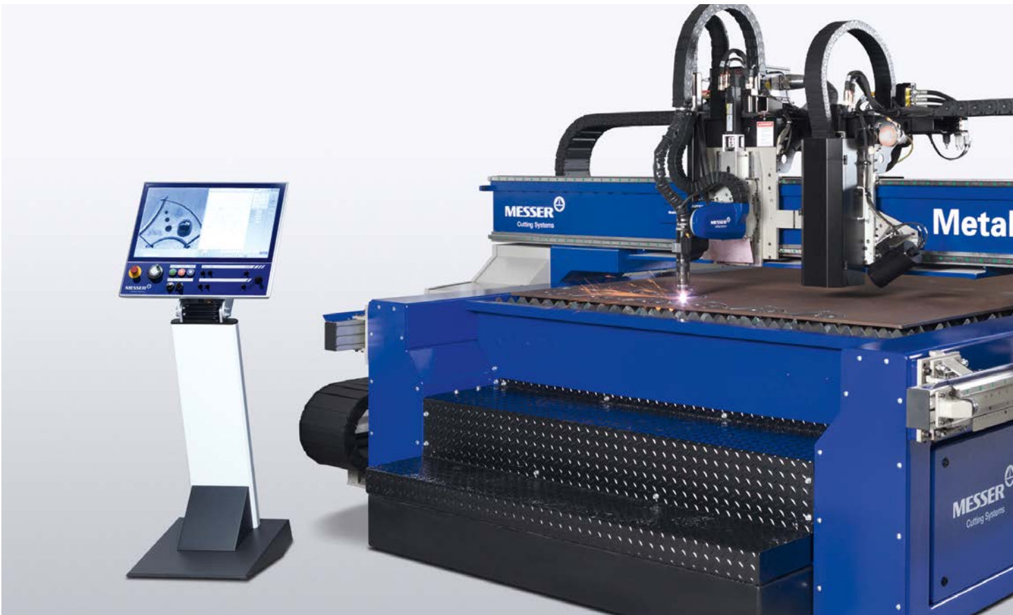
El Global Control con pantalla de 24" ofrece operaciones intuitivas para acelerar la configuración y reducir el error
