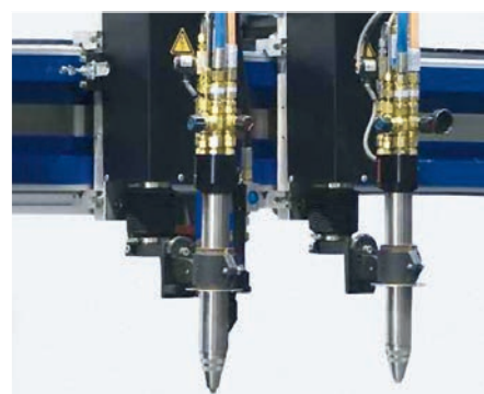
Los sopletes múltiples ALFA con cambio rápido de boquilla permiten una alta productividad.
