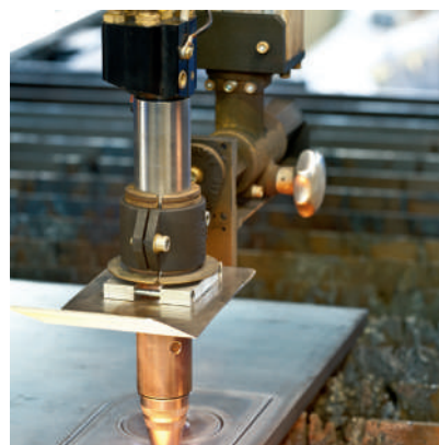
La torcha ALFA con ignición interna y sensor de altura. Tocha ALFA com ignição integrada e sensor de altura.
