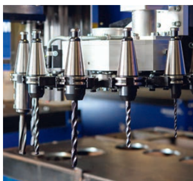
El taladro con cambiador de herramientas múltiples produce agujeros precisos e incluso roscas de grifos.
