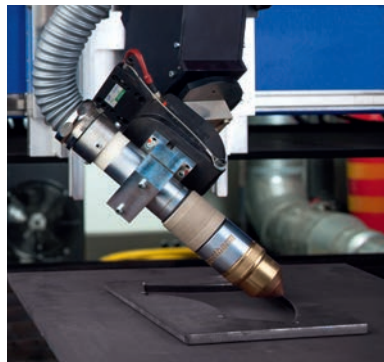
Los cortes con bisel de plasma se pueden hacer rápida y fácilmente con el Skew Delta.
