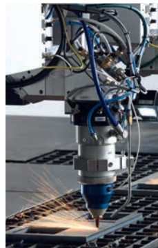
Dos cabezales láser que funcionan en paralelo hacen posible duplicar la velocidad de corte.
