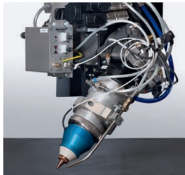
El cabezal de bisel de giro infinito, con protección magnética anticollisión permite cortes en bisel de hasta 50°
